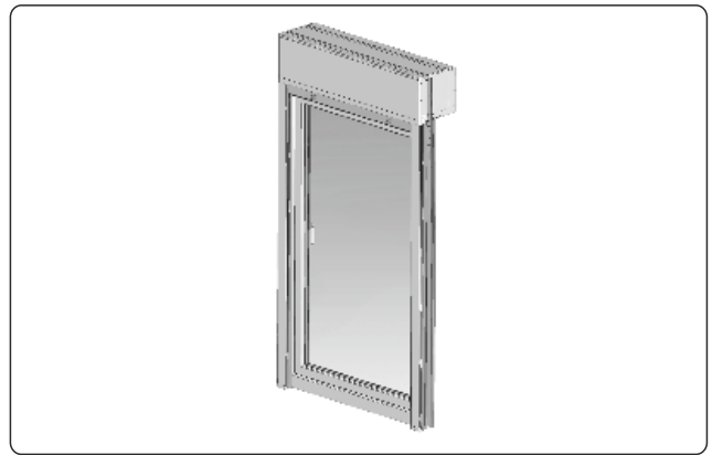
15. Auf diese Weise mit dem Fensterrahmen montierter Rollladen soll zur weiteren Montage vorbereitet werden.
